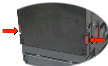
Figura 5: Apertura de la compuerta del Note Float
